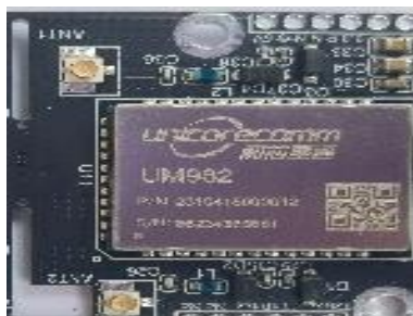
图 4.4 组合导航系统卫导天线接口位置示意图
